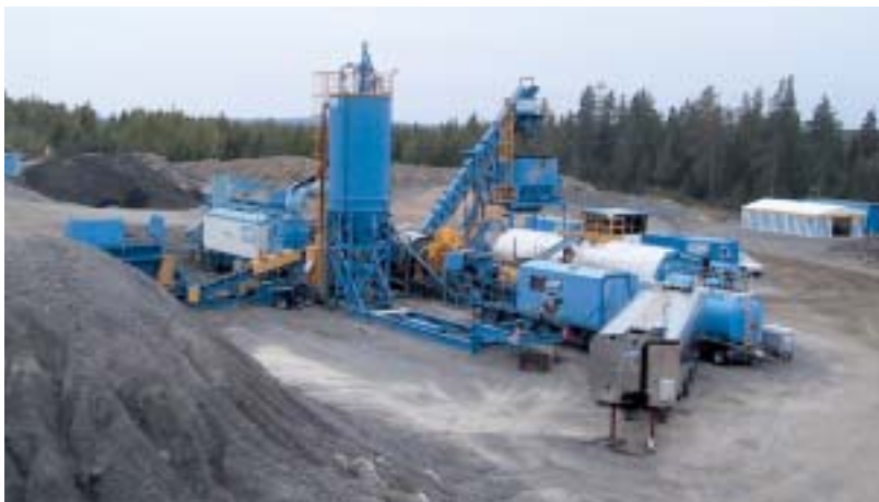
Den låga temperaturen vid tillverkning minskar energiåtgången och stoftutsläpp med 20 – 30 %.
